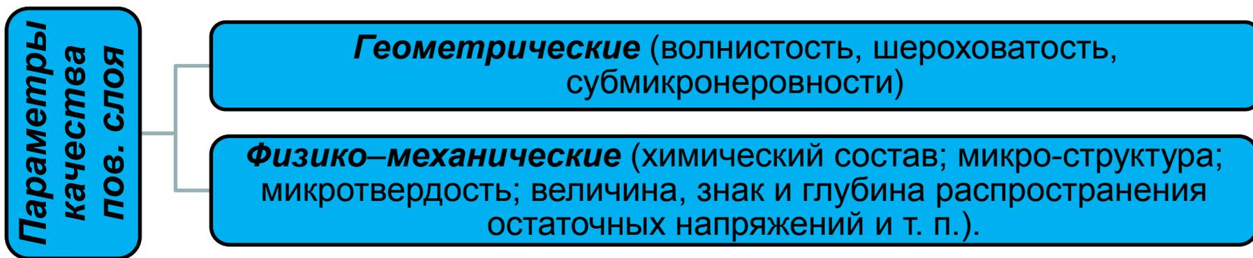
Качество поверхностного слоя определяется свойствами материала и технологией изготовления заготовки. Например, после горячей штамповки на поверхности заготовки будет окалина. Шероховатость поверхности заготовки, полученной холодной штамповкой, значительно ниже, чем заготовки, полученной горячей штамповкой, но ее поверхностный слой имеет наклеп. Если заготовка подверглась химико-термической обработке, ее поверхностный слой имеет иной химический состав и структуру, чем основа.
