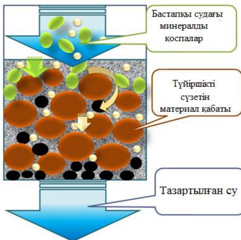
2.15-сурет – Сүзу тәртібіндегі сүзгі
